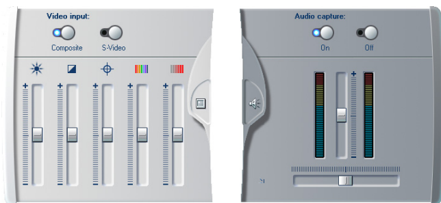
Panely videa (vlevo) a zvuku (vpravo) pro nastavení úrovní během analogového nahrávání.
